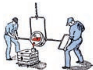
شکل ۸-۲۶ – بارریزی با کمچه و جرثقیل
