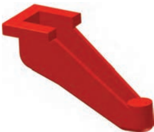
شکل ۹-۱- نمونه مدل با سطح جدایش غیر یکنواخت
