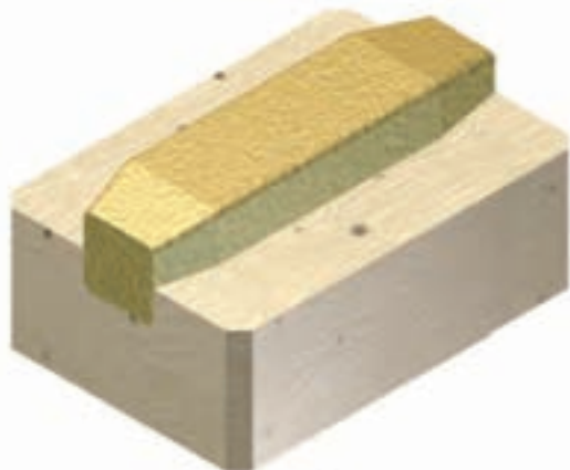
شکل ۵-۲۳- قالب گیری ماهیچه (نیمی از ماهیچه)
