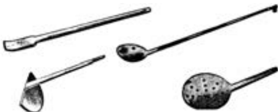
شکل ۱۷-۸ - کف‌گیر و سرباره‌گیر
